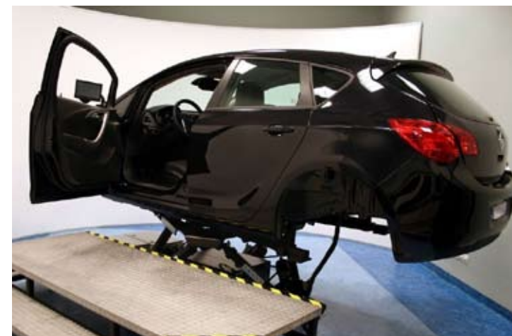
Symulator jazdy w Instytucie Psychologii UKSW: składa się z prawdziwego samochodu osobowego Opel Astra, umieszczonego na siłownikach o 6 stopniach swobody. Umożliwia generowanie wibracji o częstotliwości od 5 do 300 Hz oraz odtwarzanie efektów dźwiękowych, które towarzyszą kierowcy podczas rzeczywistej jazdy
